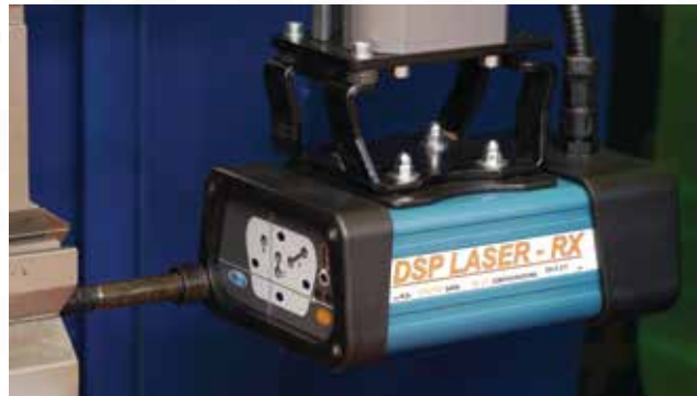
Impianto laser di sicurezza
