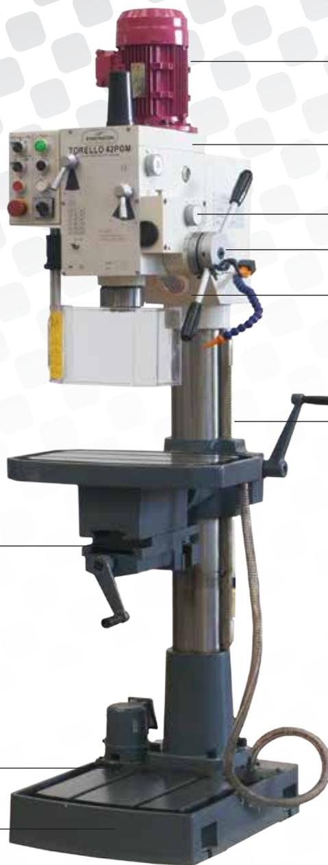
Motore a 2 velocità 1,1 kW / 1,5 kW
