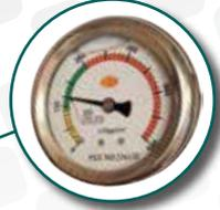
manometro idraulico controllo tensione lama
