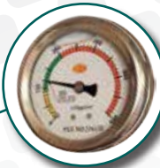
manometro idraulico controllo tensione lama
